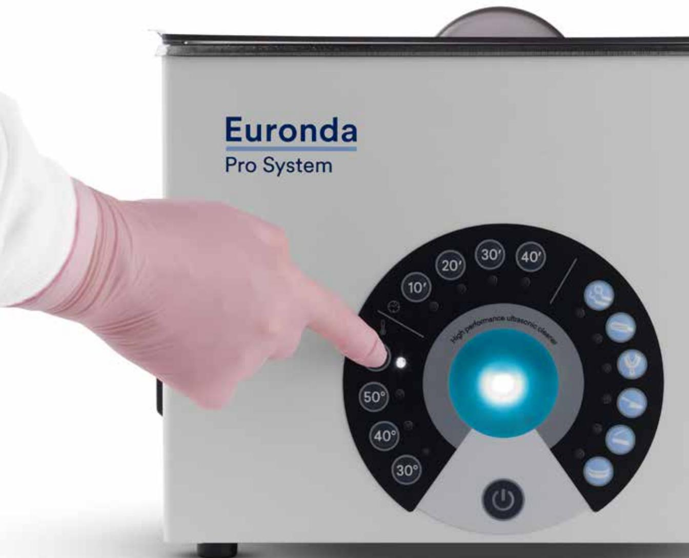
El doble campo operativo permite elegir entre 6 ciclos preconfigurados (instrumentos, fresas, cubetas de impresión, eliminación de cemento, eliminación de yeso, prótesis) y ciclos libres con una temperatura seleccionable entre 30° a 60°C y tiempo entre 10 y 40 minutos. Los seis ciclos preconfigurados tienen cuatro fases de funcionamiento diferentes: Degas, Boost, Normal e Sweep.
