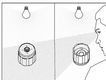
7 Terminadas las operaciones de limpieza, realizar una comprobación de la llave bajo una fuente luminosa adecuada, prestando atención a los elementos que podrían esconder residuos de suciedad (cavidades, ranuras) y, si es el caso, repetir nuevamente el ciclo de limpieza;
