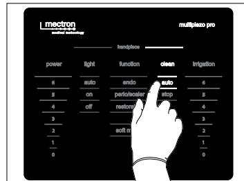
Para poner en marcha la función CLEAN mientras el teclado parpadea pisar el pedal una vez y soltarlo: el teclado deja de parpadear y el circuito de irrigación empieza a cargarse;
