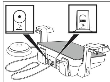
**⚠ ATENCIÓN:** en caso de que sea necesario utilizar el interruptor a pedal, desconectar el pedal del dispositivo.
