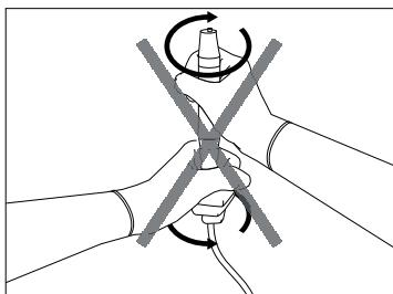
**! ATENCIÓN:** No tratar de desatornillar o de girar el conector durante la desconexión de la pieza de mano. El conector podría dañarse.
