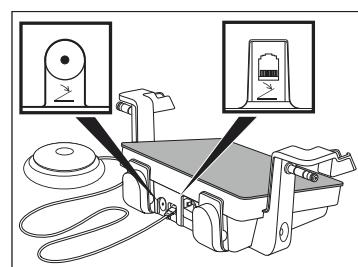
**⚠ ATTENTION:** au cas où il est nécessaire d'utiliser le button pédale, veuillez déconnecter la pédale de l'appareil.
