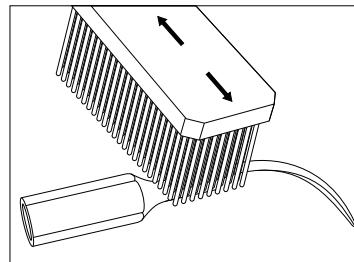
Enjuagar el canal interno del inserto con agua destilada inyectada a presión (3,8 bar) durante al menos 10 segundos, para eliminar todos los residuos;
