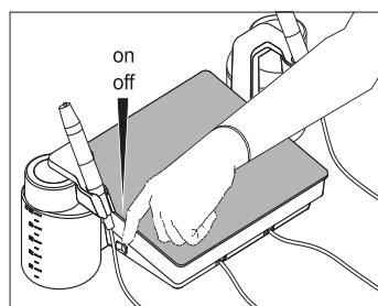
**NOTA BENE** chaque fois que l'appareil s'allume, il se place sur le réglage de défaut: "power" 1, "light" AUTO, "function ENDO, "irrigation" 1.
